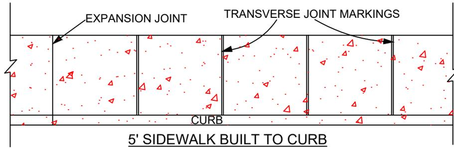
EXPANSION JOINT TO BE SPACED A MAXIMUM OF 20' APART
