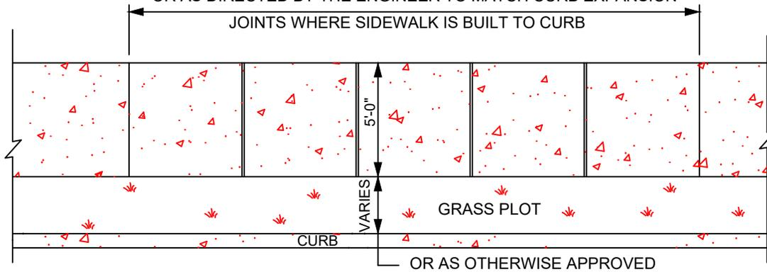
EXPANSION JOINT TO BE SPACED A MAXIMUM OF 20' APART
